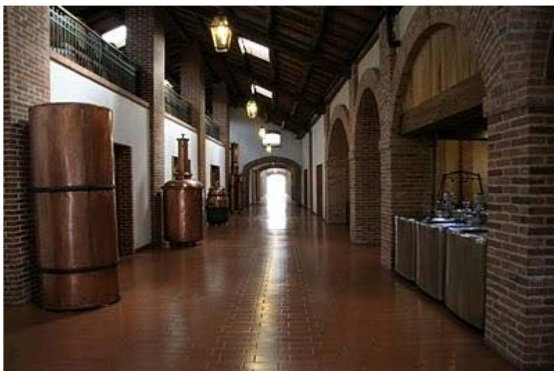
L'alambicco a vapore delle Distillerie Poli è fra i più antichi ancora in funzione. E' composto da caldaiette completamente in rame, come una volta. La **vinaccia** è riscaldata con vapore fluente e il ciclo di lavorazione è discontinuo
